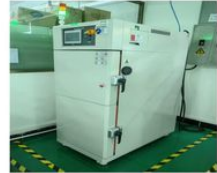
THERMAL SHOCK 冷热冲击
