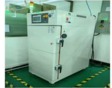
THERMAL SHOCK 冷热冲击
